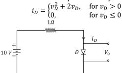
The value of  $v_D$  in the circuit is: (a)  $(-1 + \sqrt{11})V$ (b) 8 V (c) 5 V (d) 2 V
